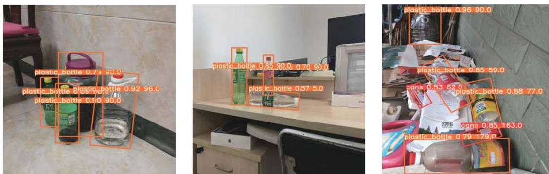
图 12 多目标物遮挡情况下的检测效果
