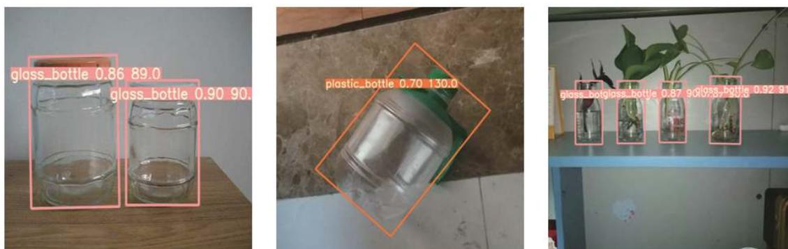
图 13 目标物透明度较高情况下的检测效果
